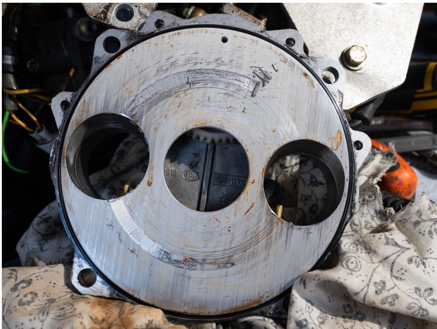
Bild 3. Spån från vevstakslagret har orsakat skador på slidskiva och hus.
