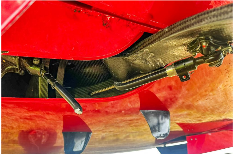
Bild 15. Staget (push-rod) som fäller in och ut landningsstället. Först har det böjts uppåt ca 100° innan det brast.
