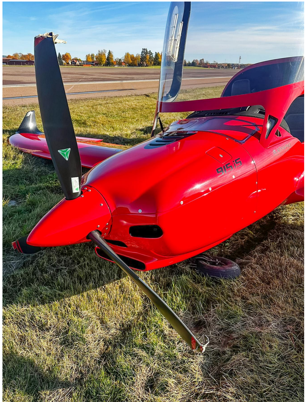
Bild 18. Skador på propeller. När rapporten skrivs har motorn redan genomgått en shock-kontroll.
