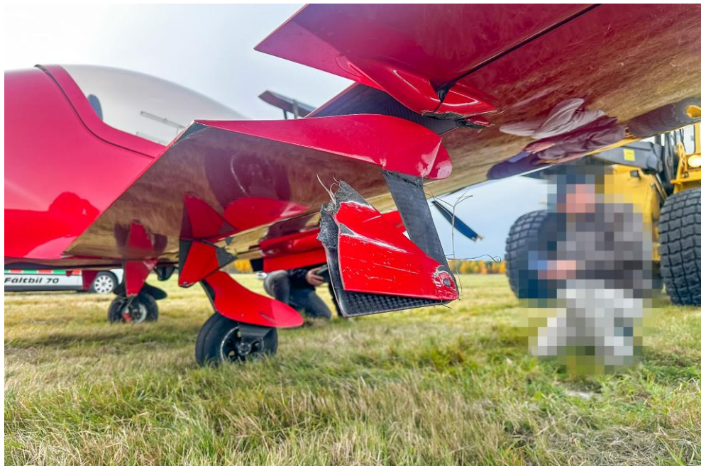
Bild 16. Skador klaff. Här lyfts flygplan inför bortforsling från haveriplatsen.
