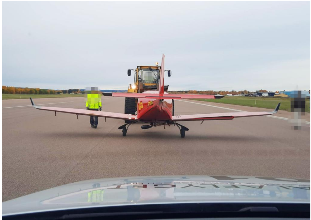
Bild 19 Höger landningsställ är fixerat med spännband under transporten. Traktorns gafflar lyfter nosen med sling i motorfästet.
